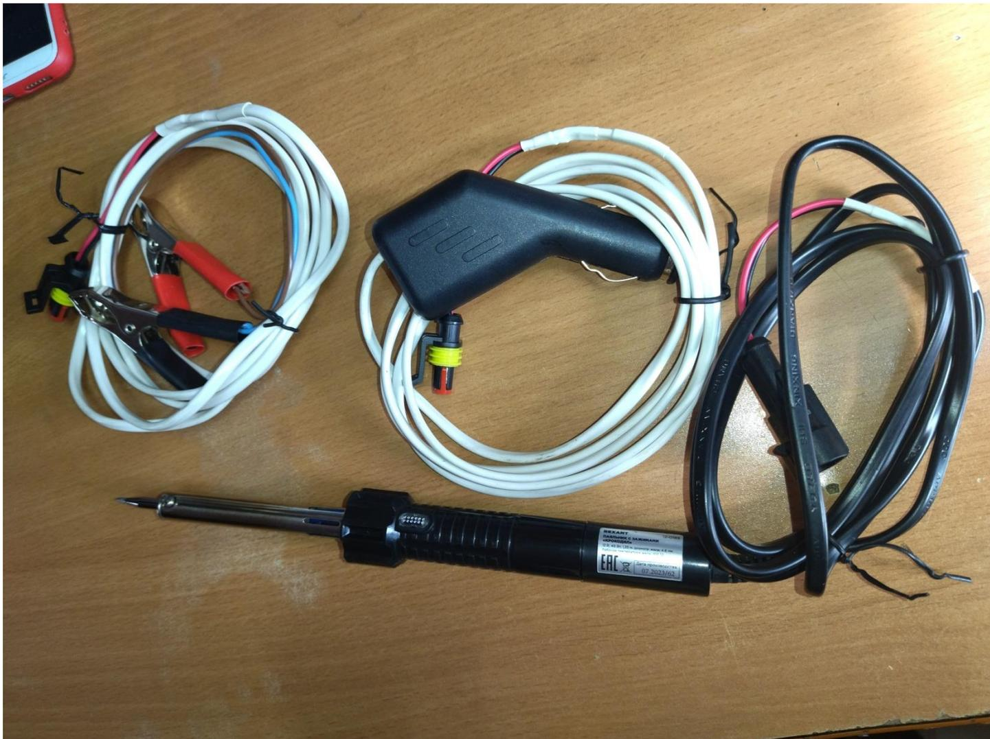
Для этого использовал 2 контактные автомобильные разъёмы, «мама» - сам паяльник и по «папе» на каждый провод. Спустился к авто, завел, подключил к прикуривателю паяльник.
